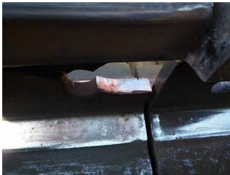
About du cœur de traversée : au niveau du trou correspondant au 3 ème boulon, un morceau de l'âme du rail a été cassé.
